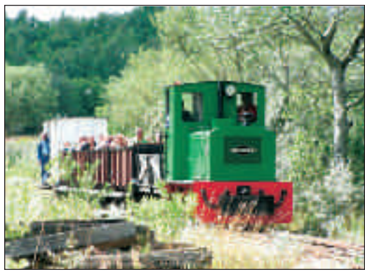
M23. Industrilokomotiv, leveret fra Deutz 1956 til Rørdal Cementfabrik, hvor det kørte kul fra havnen til fabrikken indtil 1982, hvor det kom til Hedehusene. Vægt 8,5 tons med 55 hk luftkølet dieselmotor.
